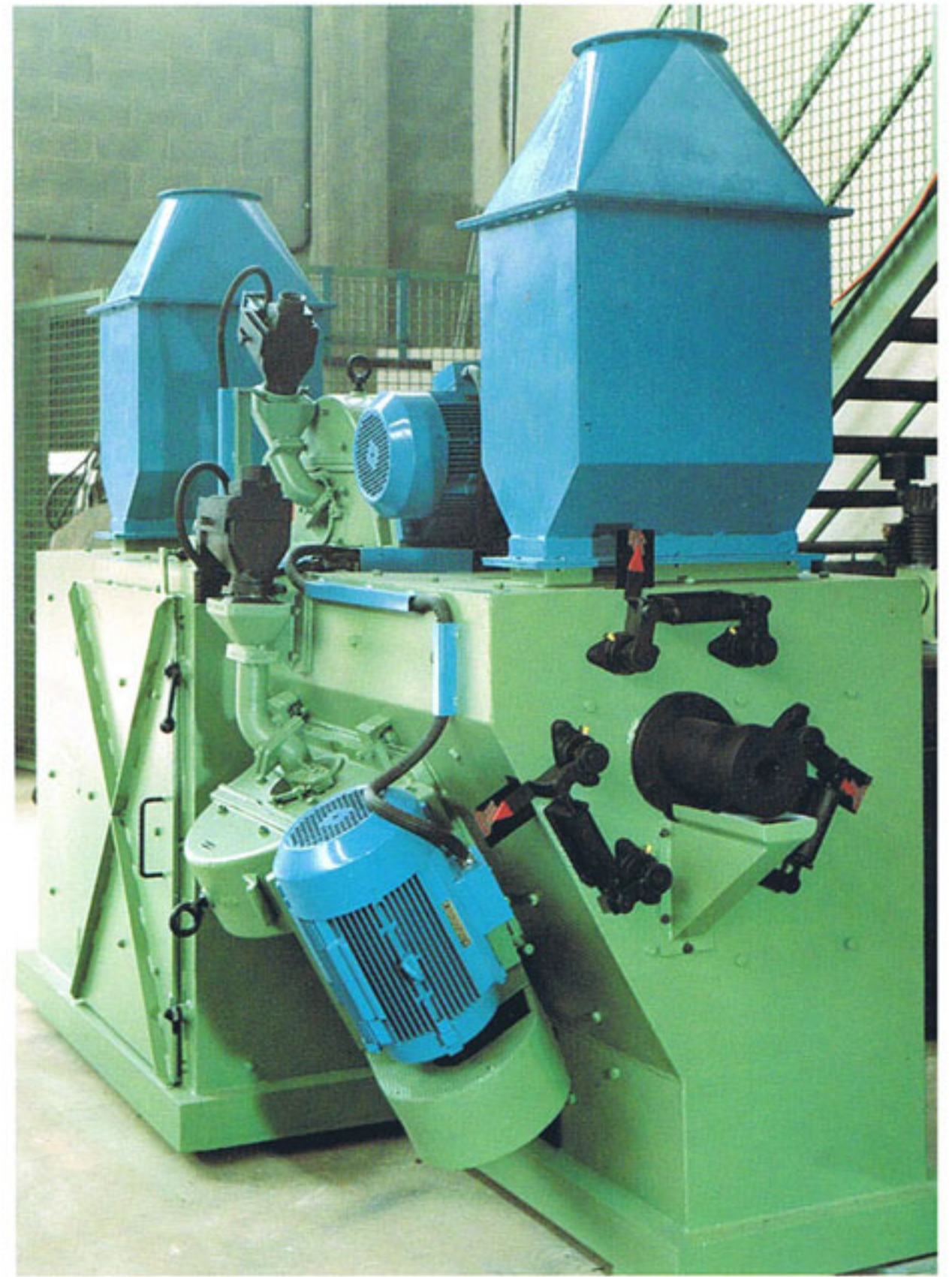
GRANIGLIATRICI PER BARRE E FILO METALLICO SHOTBLAST UNITS FOR STEEL BARS AND WIRES GRENAILLEUSES POUR BARRES ET FIL METALLIQUE
