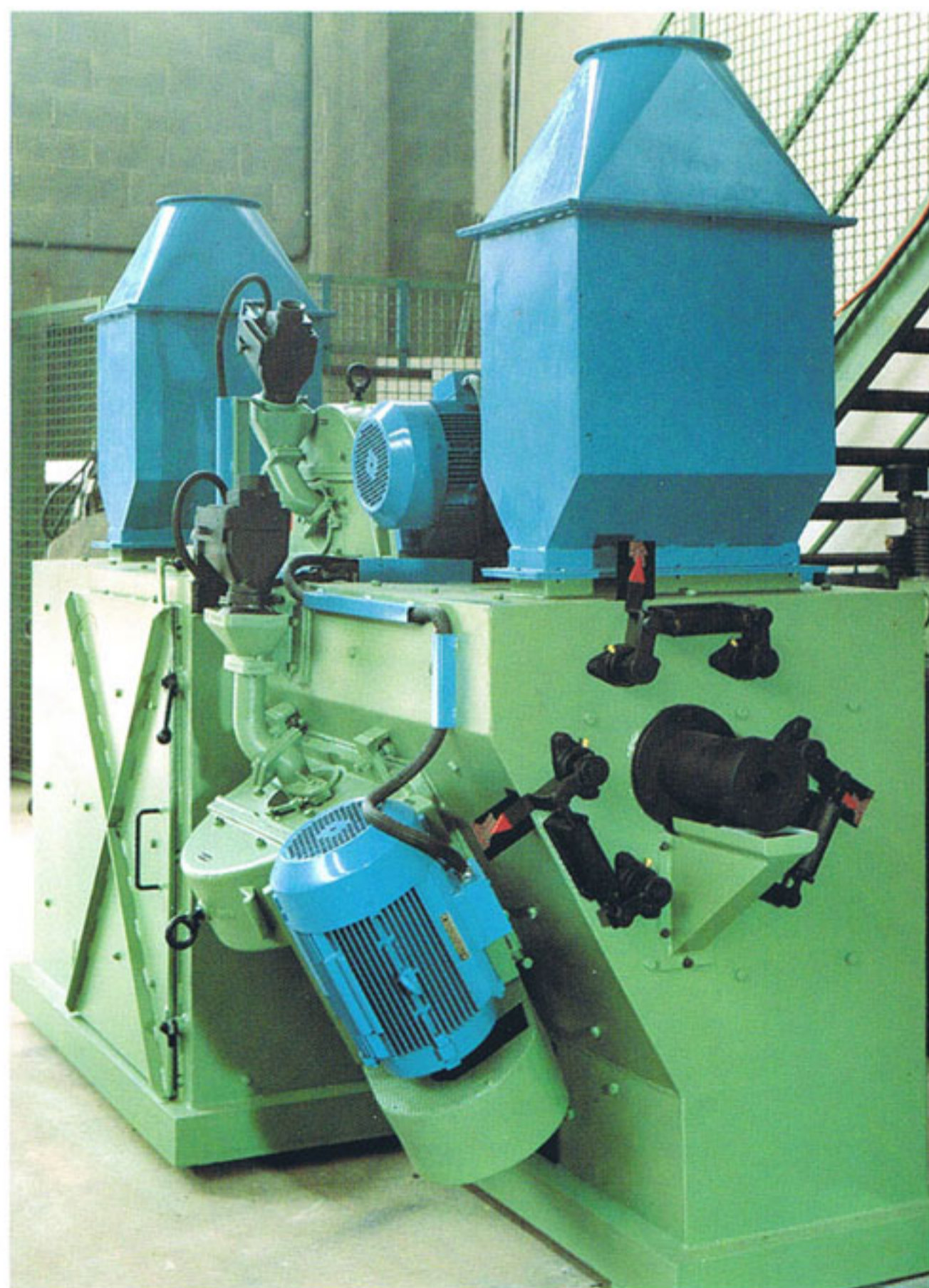
GRANIGLIATRICI PER BARRE E FILO METALLICO SHOTBLAST UNITS FOR STEEL BARS AND WIRES GRENAILLEUSES POUR BARRES ET FIL METALLIQUE
